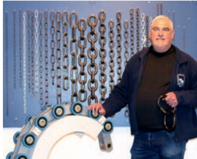
Ketten früher und heute: Fördervereinsvorsitzender Jochen Hänel vor der Wand mit Rundstahlketten aus traditioneller Produktion. Vorn eine maschinell hergestellte Förderkette, zum Beispiel für eine Achterbahn.
